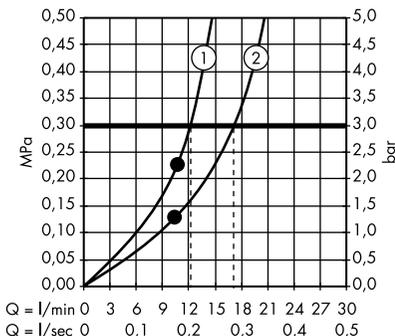
1. Con riduttore di portata (12 l/min)
