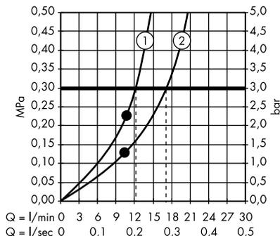
1. Con riduttore di portata (12 l/min)
