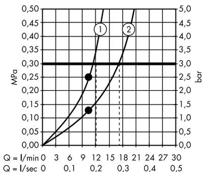
1. Con riduttore di portata (12 l/min)
